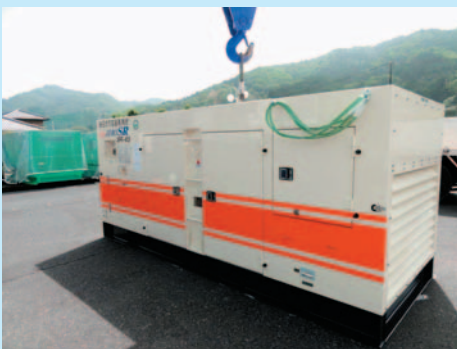
SR油圧ユニット
